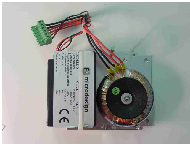
Batteriepack / Transformator
