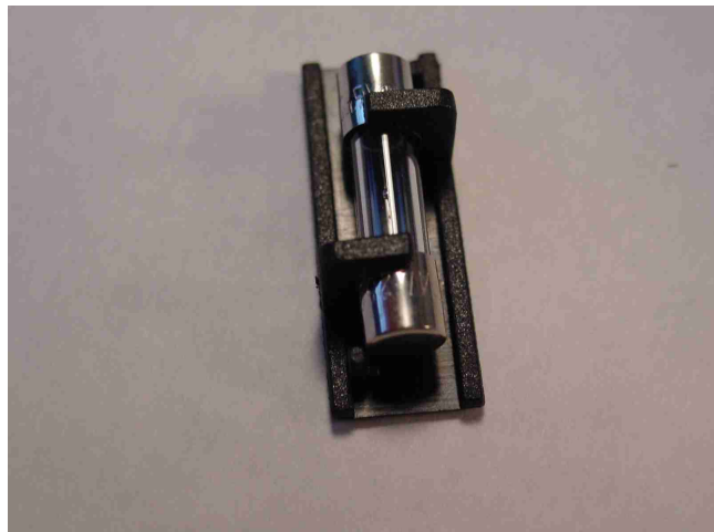
Deckel des Sicherungshalters mit darauf angebrachter Sicherung
