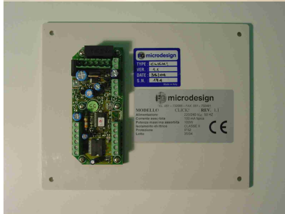
Elektronische Steuerkarte (1), wie sie auf der Tafel montiert wird
